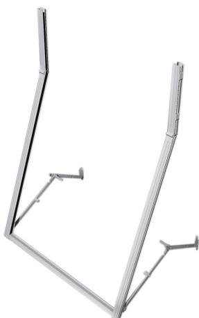
Guide 32x28 in alluminio con guarnizione, parte superiore spaccata per invito tapparella e fori per posa in opera.
