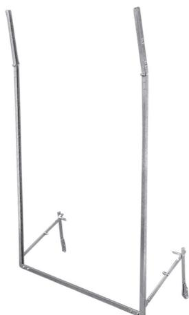
Guide 29x19x29 in ferro zincato con parte superiore spaccata per invito tapparella e fori per posa in opera.
